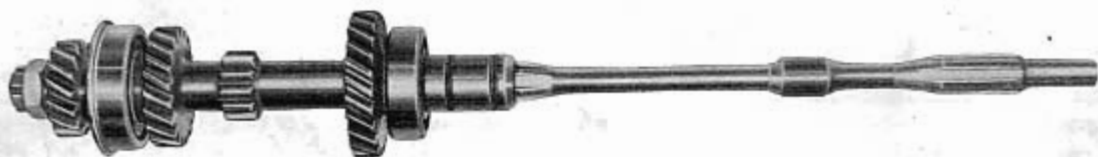
Fig. 179 - Arbres primaire et secondaire avec pignons entraîneurs et roulements à billes.
