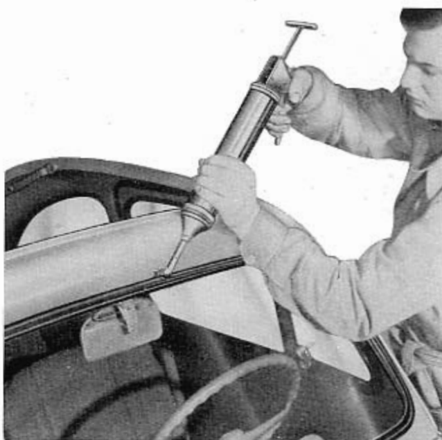
Fig. 408 - Application, au moyen d'une seringue, de mastic entre la garniture et la coque, du côté extérieur du parebrise.
