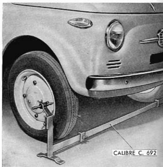
Fig. 282 - Indication du point d'appui de l'index du calibre C. 692.
