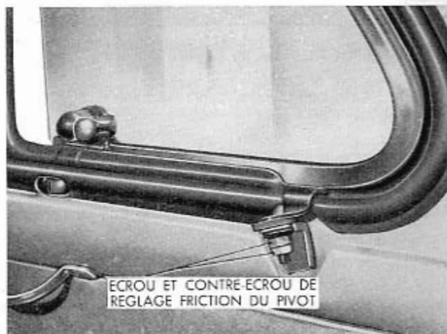
Fig. 403 - Détail de l'articulation inférieure de la vitre pivotante.
