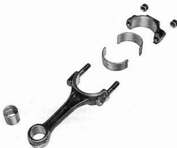
Fig. 38 - Vue éclatée de la bielle.
