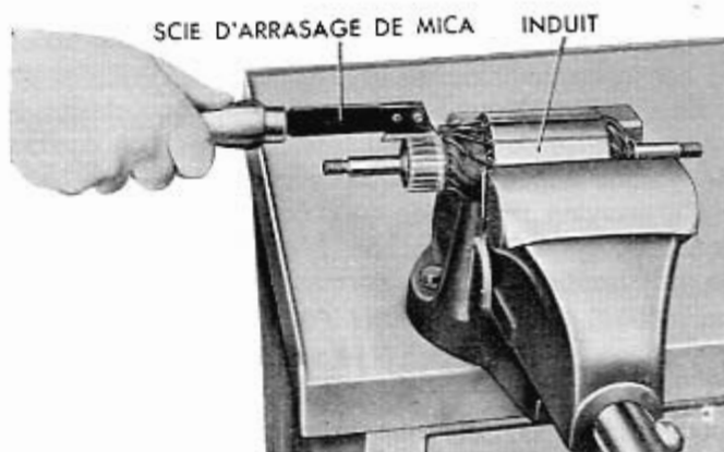
Fig. 326 - Arrasage de l'isolant entre les lamelles du collecteur, au moyen d'une scie.
