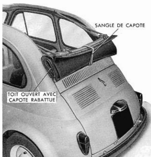
Fig. 418 - Aménagement de la capote du toit ouvrant. Il est nécessaire de replier la capote avec soin afin de ne pas endommager la lunette en vinyllite. - Avoir soin de ne pas boucher la prise d'air du moteur.
