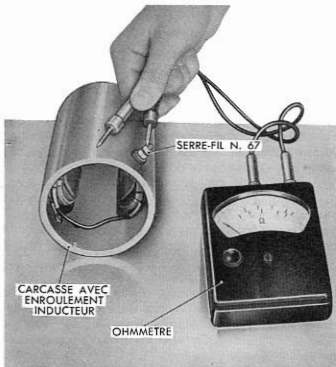
Fig. 322 - Contrôle de l'enroulement inducteur de la dynamo avec un ohmmètre.
