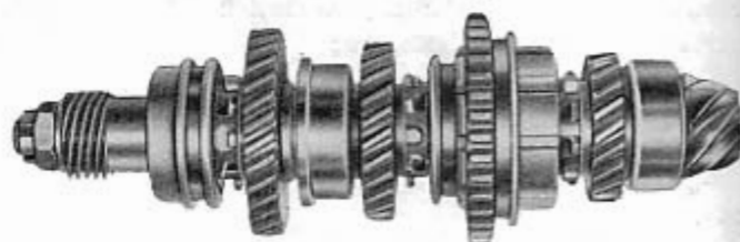
Fig. 178 - Arbre de renvoi-pignon d'attaque, complet de pignons, roulements et manchons baladeurs.
