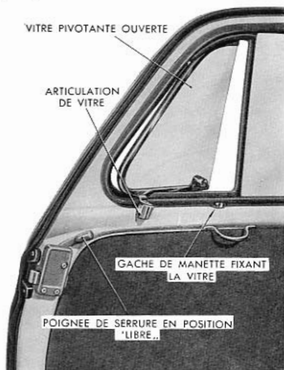
Fig. 304 - Vue intérieure de la porte côté opposé direction; le déflecteur d'air est partiellement ouvert.
