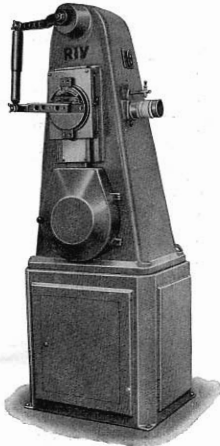
Fig. 262 - Appareil A. 76003 pour essayer le fonctionnement des amortisseurs hydrauliques.
