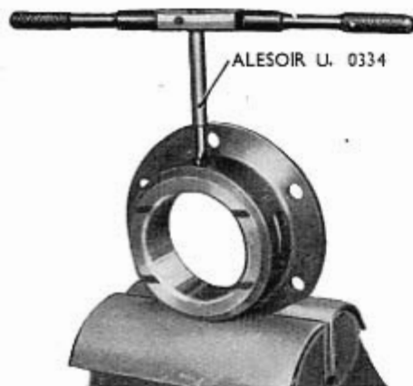
Fig. 61 - Alésage du trou de téton sur palier côté distribution.
