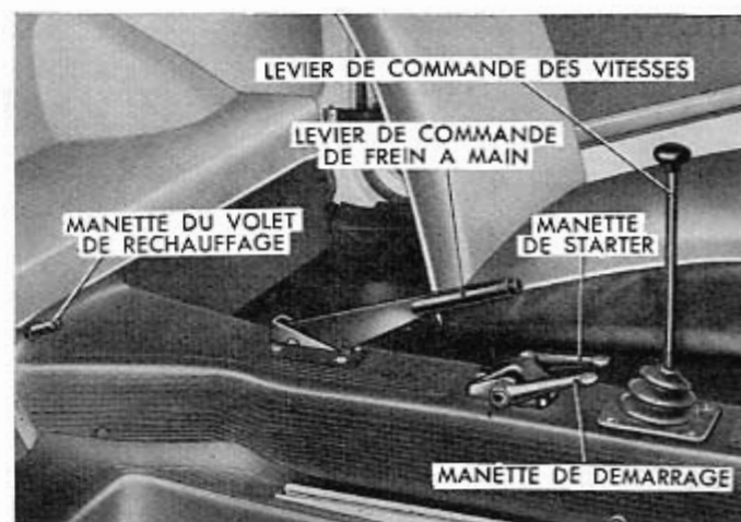
Fig. 305 - Commandes sur le tunnel central du plancher.
