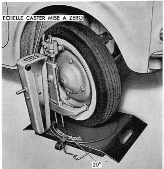
Fig. 242 - Vérification de l'angle de chasse du montant des roues avant.
