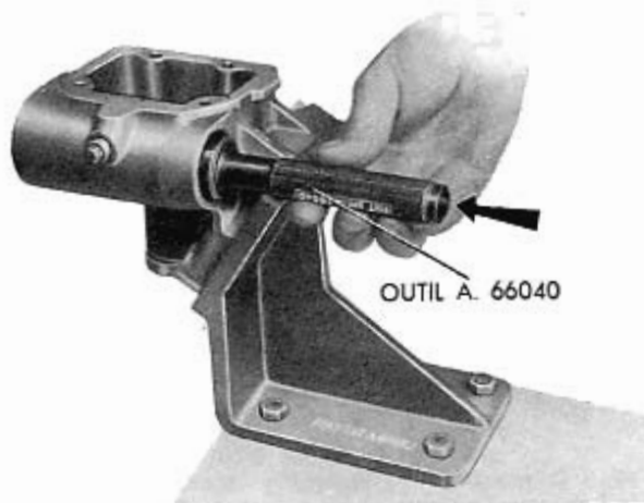
Fig. 269 - Démontage de la bague extérieure du roulement supérieur, à l'aide de l'outil A. 66040.
