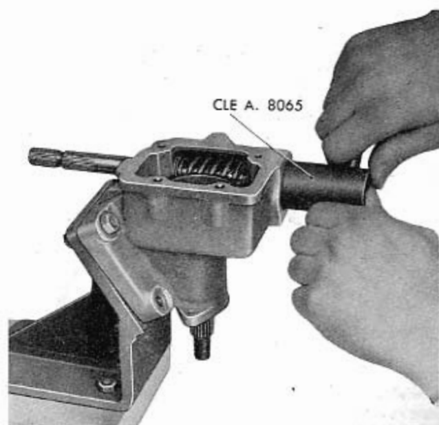
Fig. 268 - Démontage du manchon inférieur de fixation du roulement et de réglage de la vis sans fin, au moyen de la clé A. 8065.
