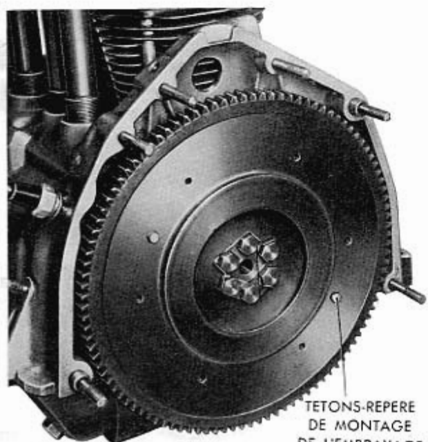
Fig. 157 - Tétons de repère sur le volant, pour monter l'embrayage.
