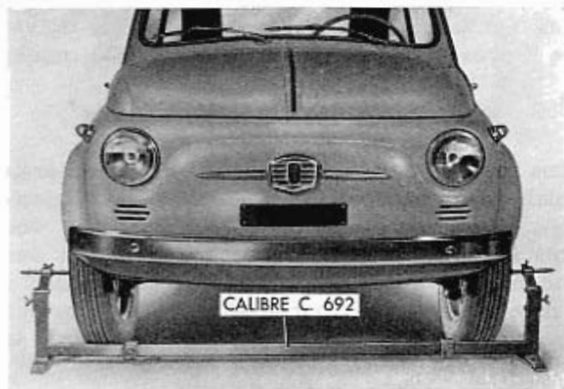
Fig. 281 - Contrôle du pincement des roues avant avec le calibre C. 692.
