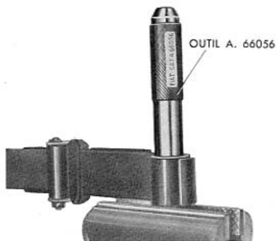
Fig. 217 - Outil A. 66056 pour démonter et monter l'estendbloc dans l'oeil de la lame maîtresse.
