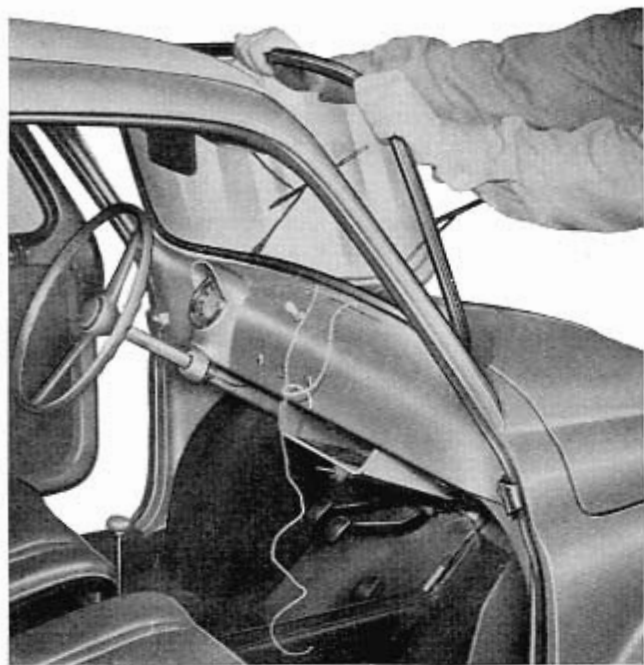
Fig. 406 - Aménagement du parebrise dans son siège, après avoir renversé les deux raclettes de l'essuie-glace.
