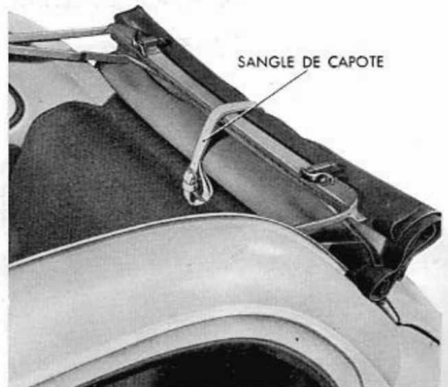
Fig. 417 - Détail de la fixation du toit ouvrant avec capote repliée.
