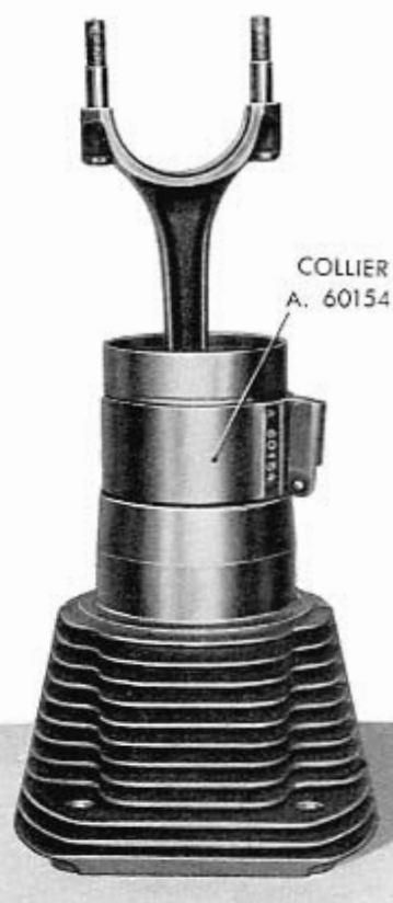
Fig. 36 - Collier A. 60154 pour introduire les pistons dans les cylindres, complets de leurs segments.
