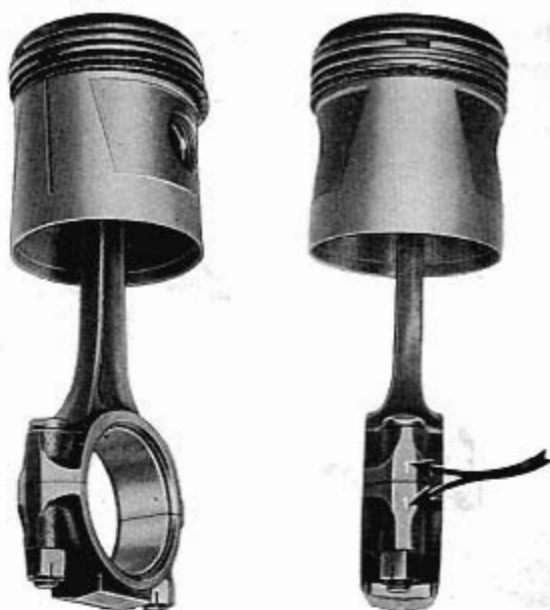
Fig. 49 - Bielles complètes de leur piston. A remarquer la position de la coupe élastique du piston par rapport au numéro-repère de la bielle.
