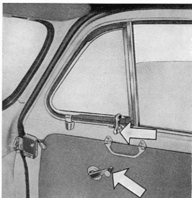
Fig. 397 - Détail de la porte droite, côté opposé à la direction. La flèche supérieure indique la poignée de blocage de vitre pivotante. La flèche inférieure indique la manivelle de lève-glace.
