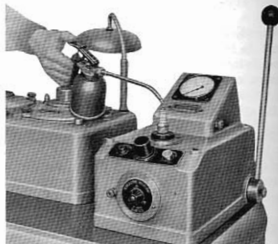
Fig. 371 - Essai de l'étanchéité d'une bougie.
