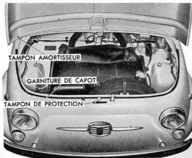
Fig. 412 - Garnitures et tampons élastiques de capot avant.
