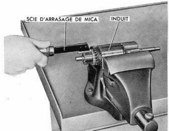
Fig. 359 - Arrasage de l'isolant entre les lamelles du collecteur de démarreur.
