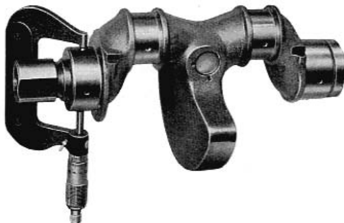
Fig. 55 - Mesure du diamètre des tourillons au micromètre.
