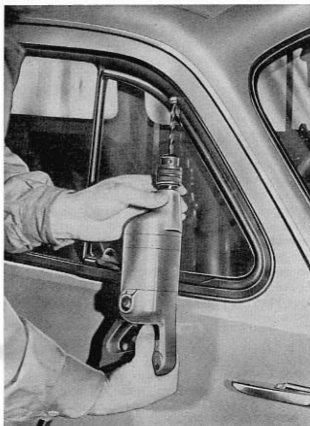
Fig. 404 - Dépose de la vitre pivotante.
