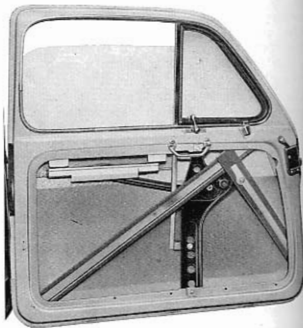
Fig. 402 - Aménagement du lève-glace à l'intérieur de la porte gauche.
