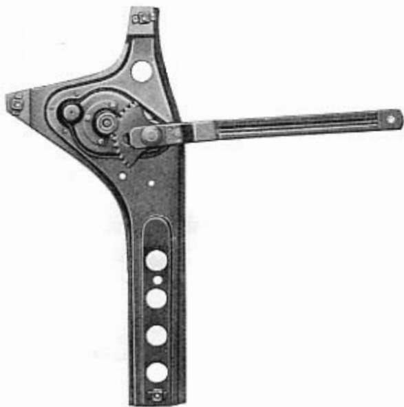
Fig. 401 - Ensemble lève-glace de porte gauche, vu de l'intérieur de la porte.
