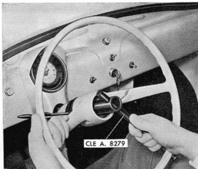
Fig. 266 - Démontage de l'écrou retenant le volant à l'arbre de direction, au moyen de la clé A. 8279.
