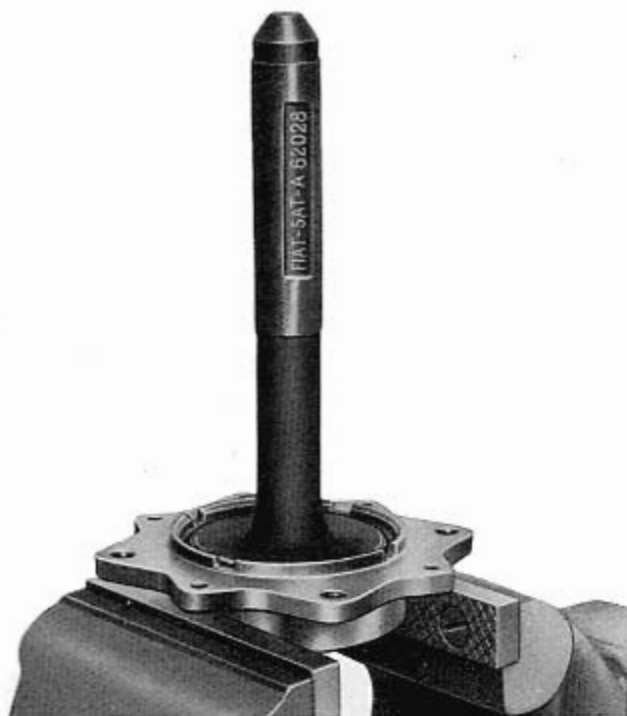
Fig. 198 - Emploi de l'outil A. 62028 prévu pour démonter et monter les bagues extérieures des roulements à rouleaux du différentiel dans leurs boîtes.
