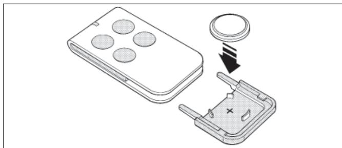
04. En tenant l'émetteur avec les touches vers le haut, remettre le couvercle en place en faisant en sorte que la « lamelle » représentée en gris se trouve au-dessus de la pile, comme l'illustre la figure ci-après.
