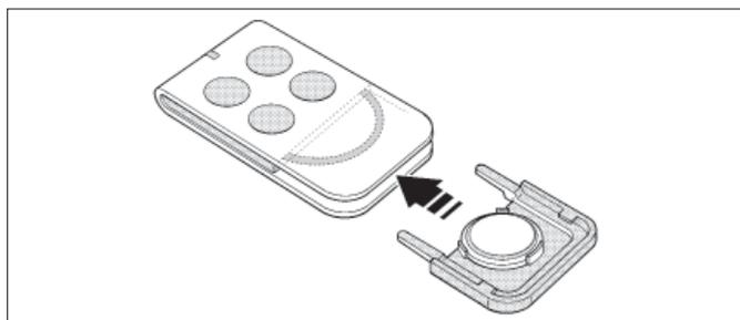
05. Pour finir, abaisser le bord du cadre sur l'arrière de l'émetteur jusqu'au dé clic.
