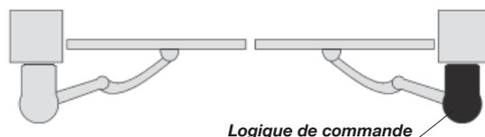
**Cas G :** pour automatiser un portail ou une porte à un seul vantail, où l'opérateur avec logique de commande est positionné à gauche, procéder de la façon suivante :
